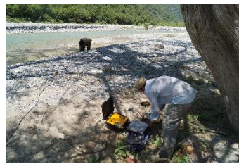
Tendidos sísmicos de refracción para presas de almacenamiento.
