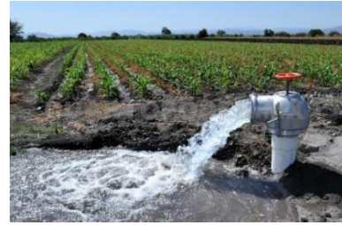
Ejecución de pruebas de bombeo
