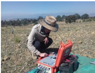
Exploración geofísica mediante sondeos magnetotelúricos, trabajo de campo.
