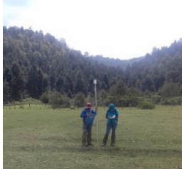
Trabajo de campo utilizando la técnica de magnetometría aplicada a la geotermia
