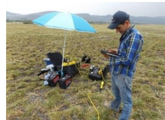
Exploración geotérmica de campo utilizando el método de tomografía eléctrica.
